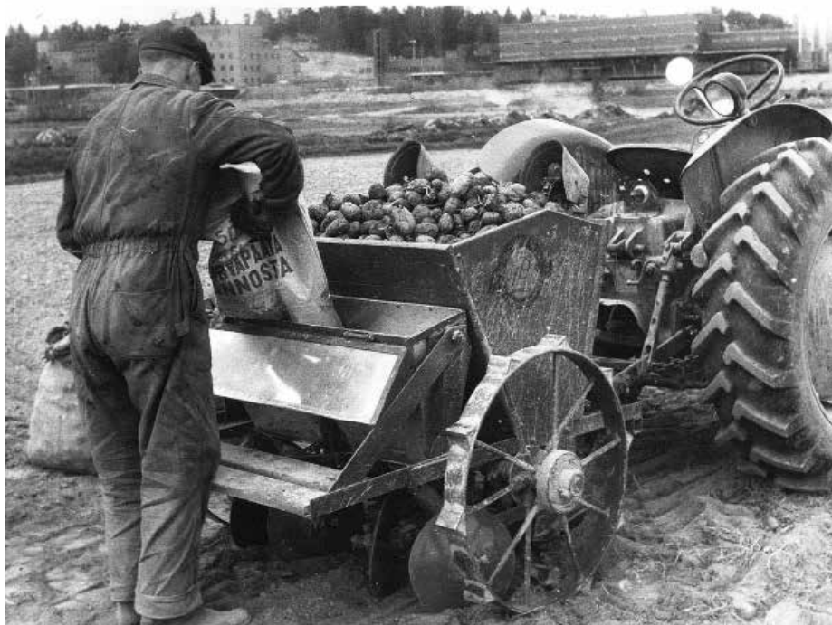
Tutkimuksen mukaan 2 rivisellä lovikoneella perunan istutuksen työsaavutus oli 30 aaria tunnissa keskimääräisissä olosuhteissa.
