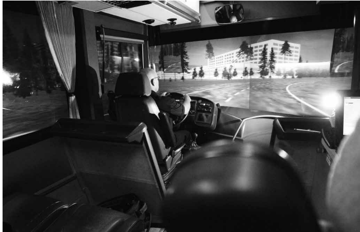
Bussin ja yhdistelmäajoneuvon kuljettajat harjoittelevat koulutuksen alussa simulaattoreiden avulla. Koulutusajoista 10 prosenttia saa olla simulaattorilla tapahtuvia ajoja.
