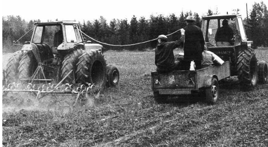
1970-luvun puolivälissä selvitettiin paripyörien vaikutusta traktorin heiluntaan kynnöstä muokattaessa. Samanaikaisesti mitattiin kuljettajan sydämen sykettä.
