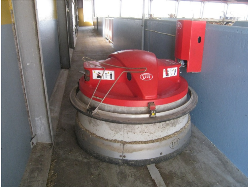
Kuva 2. Erilaiset robotit ovat yleistyneet karjatililla. Kuvassa on rehua ruokintapöydällä siirtävä robotti lataamassa akkujaan.
